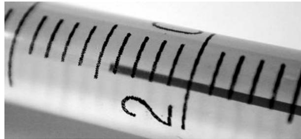
Zu dieser zufälligen Unsicherheit kommt als *Typischer Wert* (Was zeigt das Thermometer an? Angabe auf der Skala). Ein typischer Wert für das verwendete Laborthermometer ist  $u(T)_B = 0,15$  Grad; diese Fehlergrenze steht auf der Thermometerskala. Als kombinierte Messunsicherheit erhalten Sie damit  $u(T) = u(T)_A + u(T)_B = 0,25$  Grad +  $0,15$  Grad =  $0,4$  Grad.
