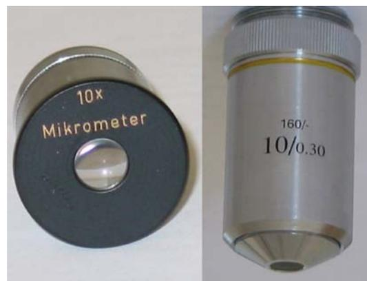
6  $\gamma_{\text{ok}}$  und  $\gamma_{\text{obj}}$  sind für die genormte Tubuslänge  $t = 160$  mm auf Objektiven bzw. Okularen eingraviert
