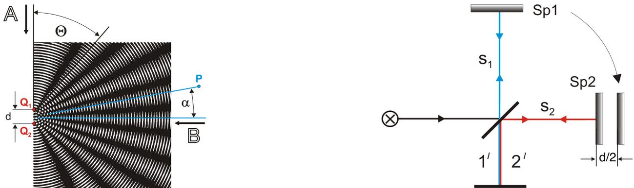
(a) In der Beobachtungsrichtung B beträgt der Gangunterschied zwischen den interferierenden Wellenzügen nur wenige Wellenlängen.
